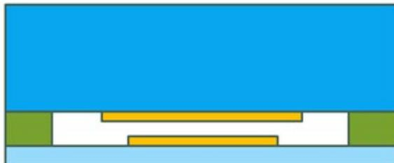
圖 1：陶瓷電容壓力感測器承壓前約束圖
